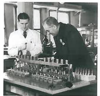
Konstruktören Franz Kilger t. h. inspekterar byggandet av hans effektiva och kostnadsbesparande tolvspindliga läppningsmaskin. Året är 1950, och maskinen användes vid CVM med stor framgång ett 20-tal år. Instrumentmakare John Olsson assisterar. Foto: Göte Jakobsson.
