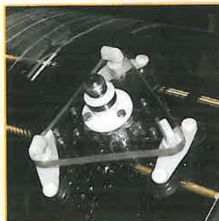
Urfräsning av skada
